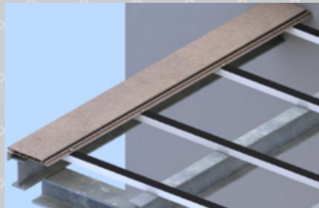
Schritt 2 Konstruktion Beton Konterlager/Dielen
