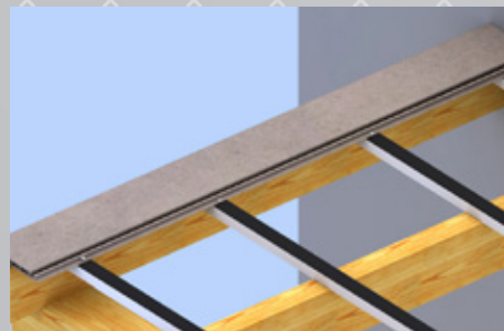
Schritt 2 - Balkon Konstruktion Holz Konterlager / Dielen
